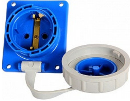
Малюнок 1.- Силова розетка, що вбудовується 2P+Z, 250В, 16А, IP68 Shuko, 096.
